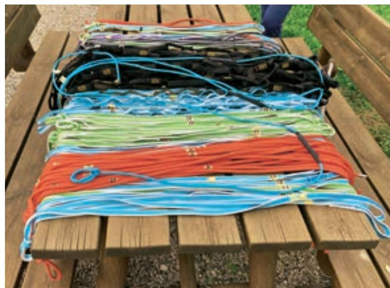
logie di materiali (Nylon®, Kevlar® e Dyneema®) testando svariate tipologie di longe realizzate con mezza corda, anelli annodati in Kevlar®, fettucce precucite in Nylon® e Dyneema® di varia larghezza oltre alle Daisy Chain.
