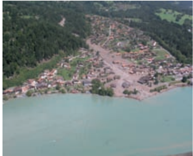
Piena a Brienz (agosto 2005). Il centro del paese è stato travolto dalla frana, trasformata in un canale. Degli edifici distrutti, alcuni non potranno essere ricostruiti, poiché il dimensionamento delle capacità di deflusso esige un canale di scorrimento più ampio.
