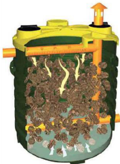
• Figura 22 – Schema filtro percolatore.
