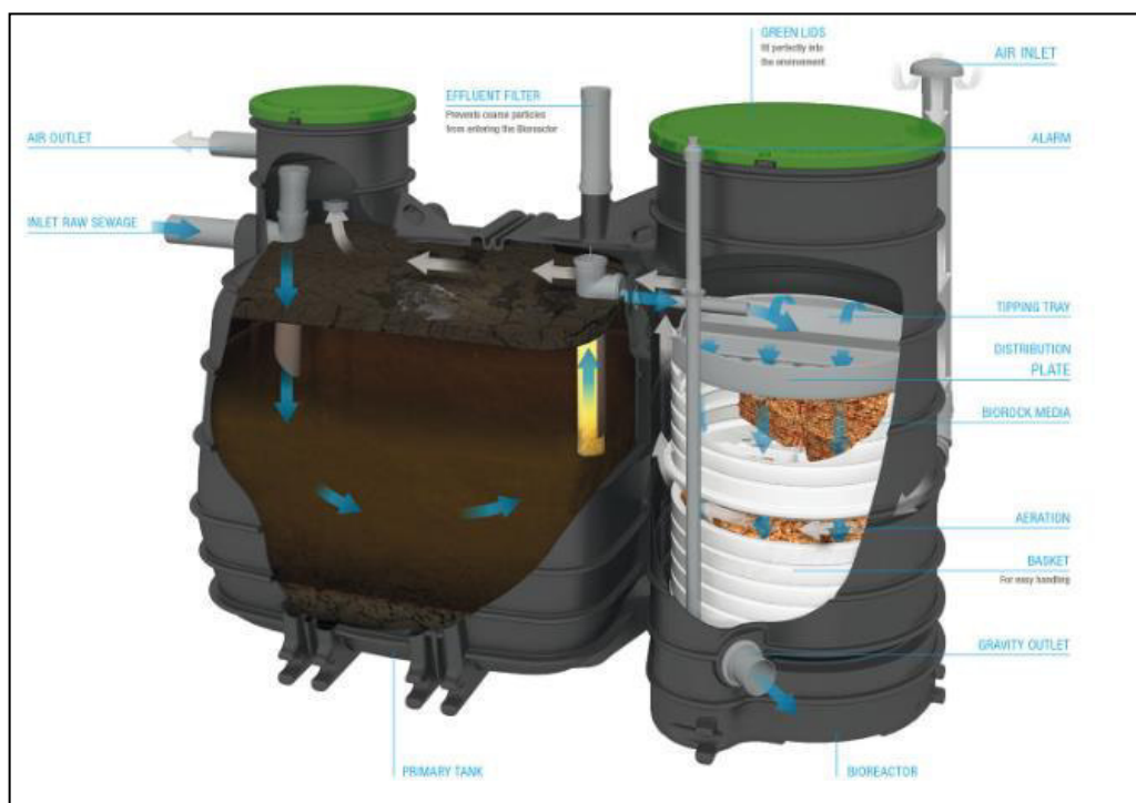
• Figura 17 – Schema funzionamento MONOBLOCK
