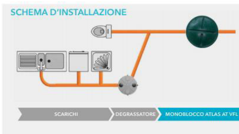
• Figura 21 – Schema installazione dell'impianto ATLAS AT.
