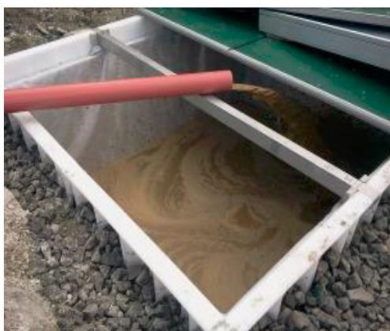
Esempio di vasche di essiccamento
