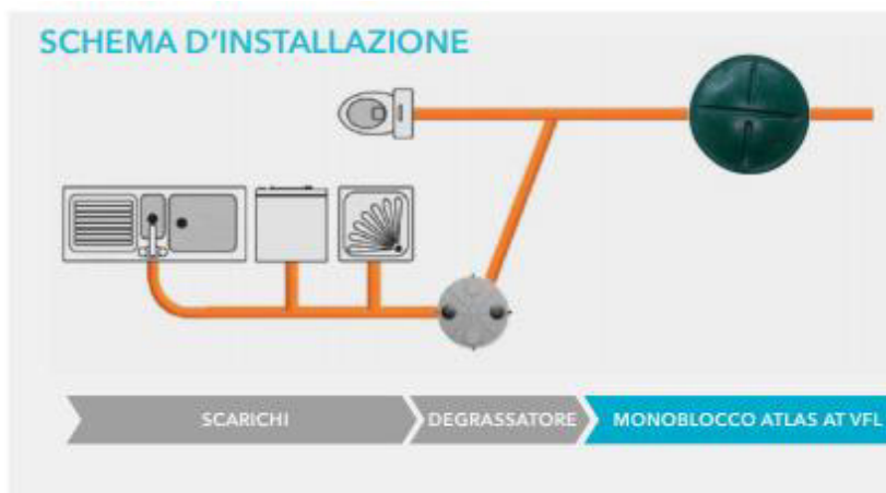
• Figura 21 – Schema installazione dell'impianto ATLAS AT.
