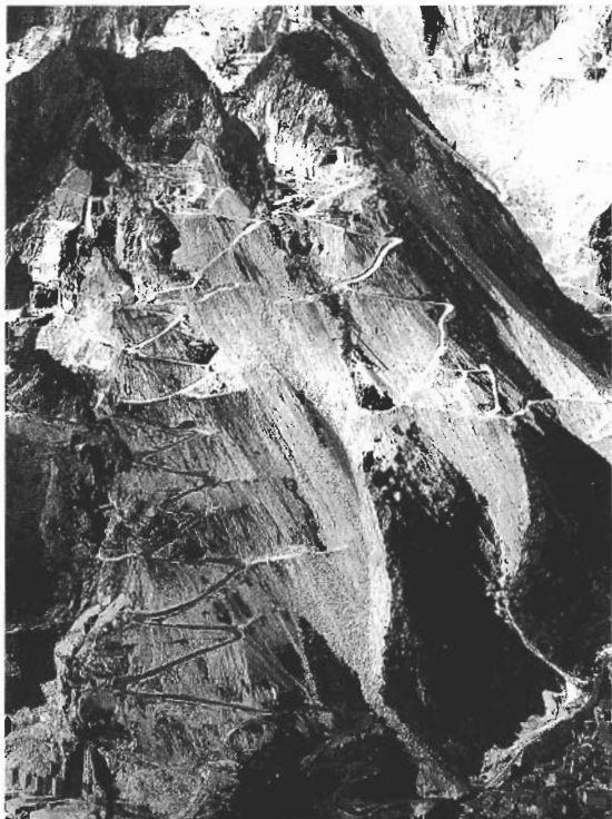
Fig. 5 - I grandi ravaneti presso il paese di Colonnata (in basso a destra) costituiscono uno degli aspetti più tipici dell'ambiente apuano; si riconoscono ravaneti attivi e ravaneti inattivi, parzialmente rimboschiti o utilizzati per le strade di arroccamento alle cave (bacino del T. Carrione, MS).
