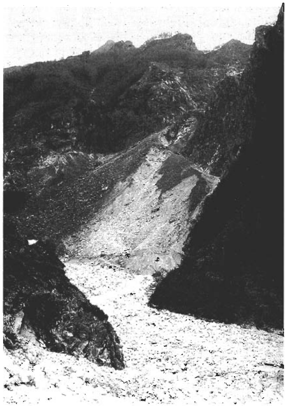
Fig. 7 - Ravaneto inattivo; sono evidenti le zone più chiare interessate da franamenti, causati prevalentemente dal prelievo di detrito nella parte inferiore (zona di Forno nel bacino del F. Frigido, MS).
