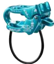
do e senza intoppi. Be Up è l'unico dispositivo a permettere, con mezze corde o corde gemelle Ø 7.3 mm, il recupero indipendente e autobloccante dei secondi; Be Up consente inoltre di sbloccare e calare progressivamente un secondo sotto tensione anche nel vuoto. Da utilizzare con mezze corde o corde gemelle Ø 7.3 ÷ 9 mm o con corde singole Ø 8.5 ÷ 10.5 mm. Per saperne di più: [www.climbingtechnology.com](http://www.climbingtechnology.com) e nuova pagina FB.
