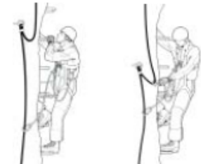
Fig. 8 - Modo corretto di passare un punto di stacco con set a Y
