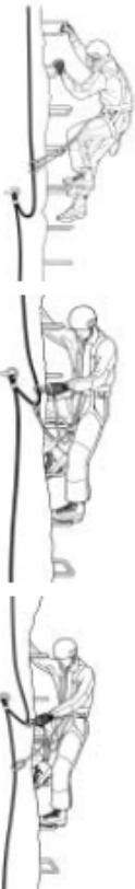
Fig. 7 - Modo corretto di passare un punto di stacco con set a Y
