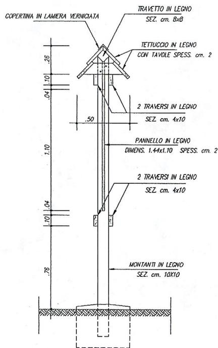
Le misure esterne massime del pannello sono di 140 x 110 cm. Il pannello va fissato su montanti del diametro di 10 cm a circa 90 cm da terra. Il tetto a protezione del pannello deve sporgere di circa 30 cm.
